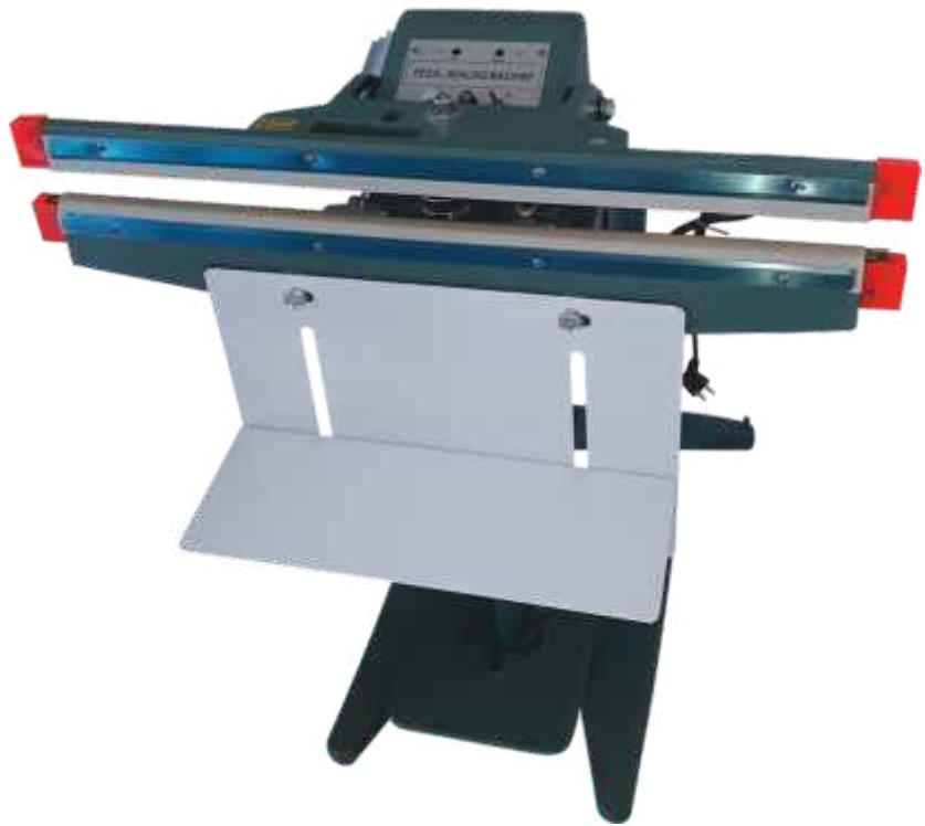
Θερμοσυγκολλητική πλαστικών και αλουμινένιων σάκων, χειροκίνητη ή με ποδοδιακόπτη και πλάτος συγκόλλησης τα 8mm. Ο χρόνος θέρμανσης είναι από 0,2 έως 2sec και η ελάχιστη διάσταση σφράγισης 100mm. Το μοντέλο ISPSF-650 διαθέτει 2 θερμαντικά σώματα των 600W και μήκος συγκόλλησης τα 650mm.
