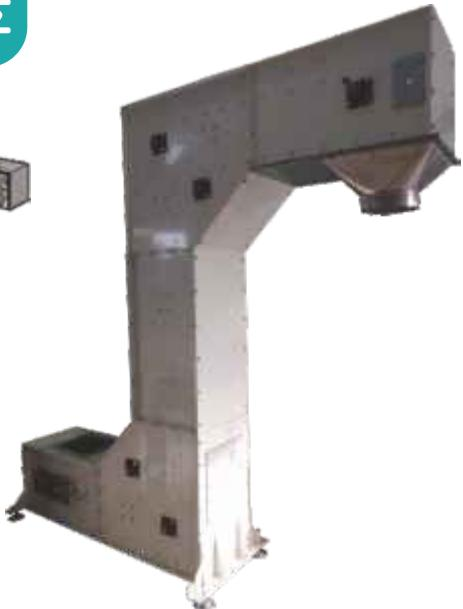
Συστήματα μεταφοράς υλικών τύπου Bucket z-elevator για όλα τα υλικά με δυναμικότητες από 1- 10 m<sup>3</sup>/h, full ίνοχ ή βαθφί κατάλληλη για τρόφιμα, καθώς και σύστημα στήριξης και ανύψωσης big bag για την τροφοδοσία του z-elevator με δονητικό σύστημα στην είσοδο.
