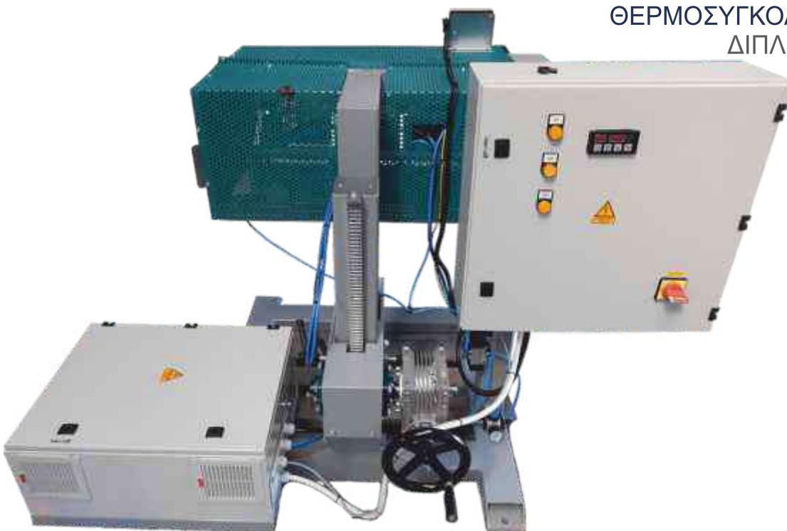
Θερμοσυγκολλητική μηχανή της εταιρείας μας, με Γερμανικό controller και αντιστάσεις με ρύθμιση θερμοκρασίας 0-300 °C. Το ύψος της κεφαλής μεταβάλλεται με μηχανικό τρόπο μεταξύ 450 – 950 mm και η μέγιστη διάσταση κεφαλής είναι τα 750 mm, για διπλή συγκόλληση με πλάτος 10 mm και ελάχιστη διάσταση σφράγισης τα 50 mm.
