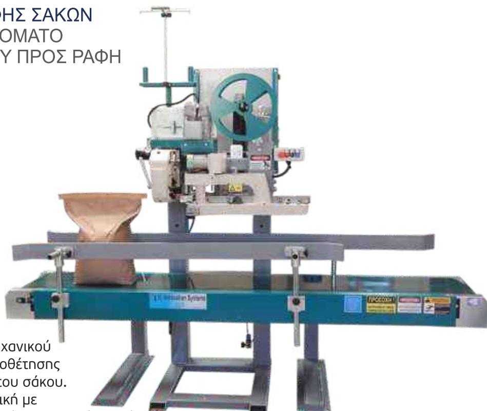
Ημιαυτόματη ραπτική μηχανή με βιομηχανικού τύπου ραπτική σύστημα κοπής και τοποθέτησης χαρτιού κρεπέ – ρέλι στο άνω σημείο του σάκου. Σύστημα μεταφοράς σάκου προς ραπτική με αυτόματο τρόπο. Αυτόματη κοπή κλωστής & χαρτιού κρεπέ. Ιδανική για όλα τα σακιά ανοιχτού στομίου στομίου με ή χωρίς πιέτα. Δυνατότητα ρύθμισης ύψους ραπτικής κεφαλής και ταινίας με πλεκτρική υποβοήθηση.
