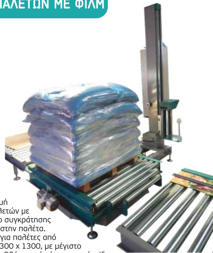
Αυτόματη γραμμή περιτύλιξης παλετών με αυτόματο τρόπο συγκράτησης και κοπής φιλμ στην παλέτα. Με πλατφόρμα για παλέτες από 800 x 1200 – 1300 x 1300, με μέγιστο ύψος 2300mm. Οθόνη αφής ή εφαρμογή wifi APP, Αυστριακού Οίκου. Έχει μηχανικό σύστημα με φρένο για σταθερή επιμήκυνση του φιλμ ή με πλεκτρική προτάνυση του φιλμ μέχρι και 300%. Προαιρετικά και σύστημα top press.
