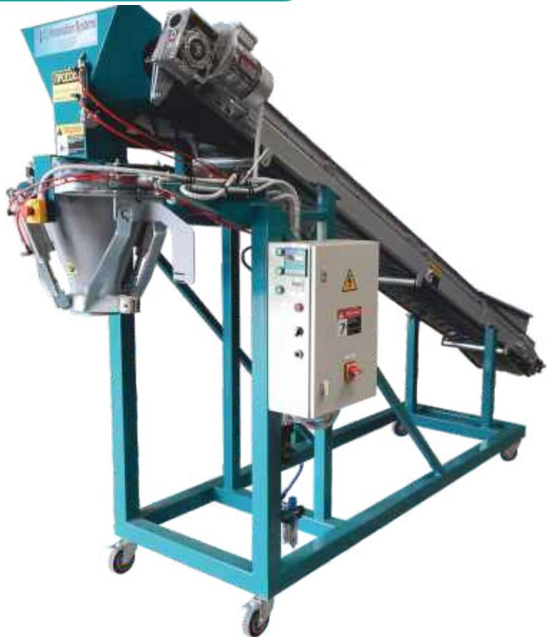
Ημιαυτόματη μοχανή συσκευασίας, με σύστημα επικλινής ταινίας για την μεταφορά του υλικού προς το σακί. Ιδανική για υλικά που δεν θέλουμε να θρυμματίζονται. Κατάλληλη για σακιά ανοιχτού στομίου ή πιέτα.
