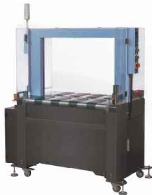
Πλήρως αυτόματη τσερκομπχανή κιβωτιών με γέφυρα διαστάσεων 850x600mm. Αυτόματος κύκλος τροφοδοσίας του επόμενου κομματιού τσερκιού, αυτόματος τρόπος μεταφοράς του τσερκιού με φωτοκύτταρα για κύκλους ανά κιβώτιο, καθώς και δυνατότητα τάνυσης 1-58Kg.
