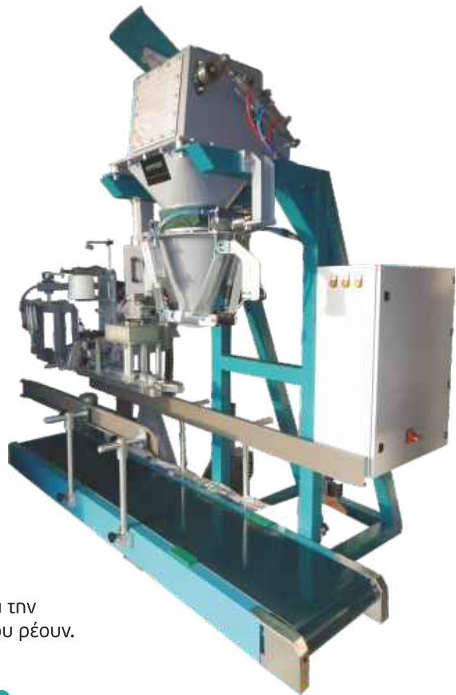
Ημιαυτόματη μηχανή συσκευασίας, με σύστημα ροής για την μεταφορά του υλικού προς το σακί. Ιδανική για υλικά που ρέουν. Κατάλληλη για σακιά ανοιχτού στομίου ή πιέτα.
