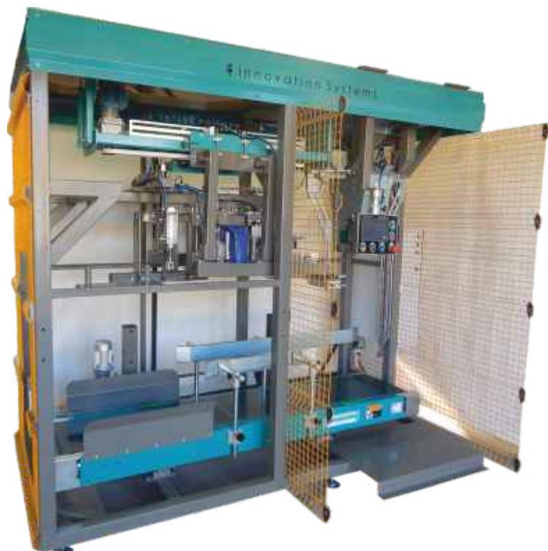
Ημιαυτόματη μοχανή συσκευασίας, εξοπλισμένη με μια ή δύο προζυγίσεις και αυτόματο σύστημα μεταφοράς σάκων προς ραφή. Κατάλληλη για σακιά με ραφή, ανοιχτού στομίου, πολυυριζόνιο, πλαστικά, χάρτινα κ.α, με πιέτα ή όχι, με διπλή κλωστή για ραφή και ραπτική κεφαλή βιομηχανικού τύπου.
