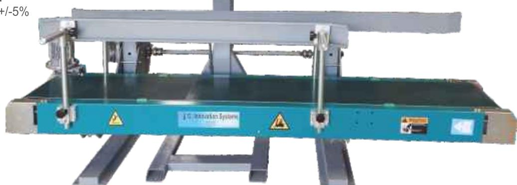
Ημιαυτόματη ραπτική μηχανή με βιομηχανικού τύπου ραπτική. Σύστημα μεταφοράς σάκου προς ραπτική με αυτόματο τρόπο. Αυτόματη κοπή κλωστής. Ιδανική για όλα τα σακιά ανοιχτού στομίου με ή χωρίς πιέτα. Δυνατότητα ρύθμισης ύψους ραπτικής κεφαλής και ταινίας μεταφοράς με μηχανική υποβοήθηση.
