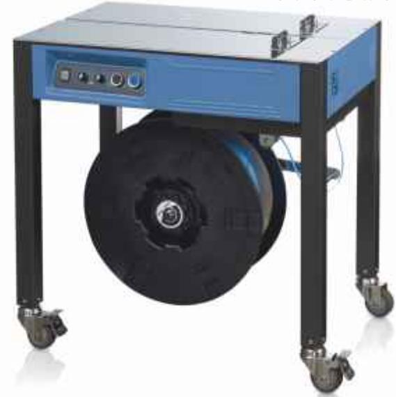
Ημιαυτόματη τσερκομπχανή κιβωτιών με πάγκο διαστάσεων 780x544mm. Με κομβίο έναρξης, αυτόματη τροφοδοσία τσερκιού μετά από κάθε κύκλο, ρύθμιση τροφοδοσίας τσερκιού και δυνατότητα τάνυσης 1-55Kg.
