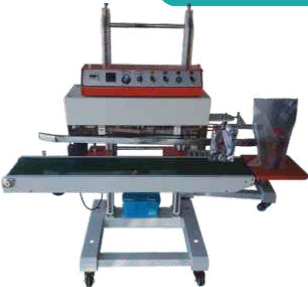
Θερμοσυγκολλητικό πλαστικών σάκων με βάση στήριξης και ραουλόδρομο κίνησης. Διαθέτει 2 θερμαντικά σώματα των 500W που μπορεί να φτάσει την θερμοκρασία των 0-300 °C. Το πάχος συγκόλλησης είναι 8 με 10mm και είναι συνεχόμενη συγκόλληση. Μέγιστο βάρος κίνησης στον ραουλόδρομο είναι τα 50 κιλά.
