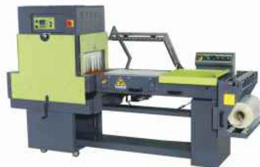
Θερμοσυρρικνωτική μηχανή με παραγωγή 400 τεμαχίων την ώρα. Το υλικό συγκόλλησης είναι PVC και ο μέγιστη διάσταση σφράγισης 420 επί 550mm (DxL) και ύψος 250mm (H). Με διάσταση ρολό φιλμ 600mm x 250mm
