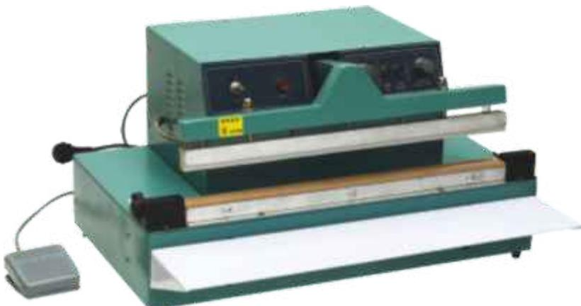
Επιτραπέζιο θερμοσυγκολλητικό πλαστικών, αλουμίνιων σάκων με μέγιστη διάσταση σφράγισης τα 450mm και ελάχιστη τα 100mm. Το θερμικό σώμα των 600W έχει την δυνατότητα σφράγισης σε 0,2 έως 1,3 sec με πλάτος συγκόλλησης 8 mm και πάχος 0,5mm.
