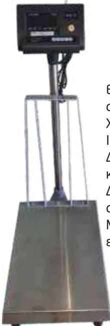
Επιδαπέδια ζυγαριά με πλατφόρμα από ανοξείδωτο ατσάλι AISI 304, διαστάσεων 400x600mm. Χρησιμοποιεί δυναμοκυψέλες τύπου SINGLE POINT IP65, CLASS C. Διαθέτει ψηφιακό ενδείκτη ζύγισης με 6 ψηφιακά κόκκινα LED μεγέθους 20mm. Δέχεται τροφοδοσία 230V AC αλλά έχει και μπαταρία αυτονομίας 10 ωρών. Μπορεί να συνδεθεί με άλλα μηχανήματα με θύρα επικοινωνίας RS232, καθώς και με εκτυπωτή.
